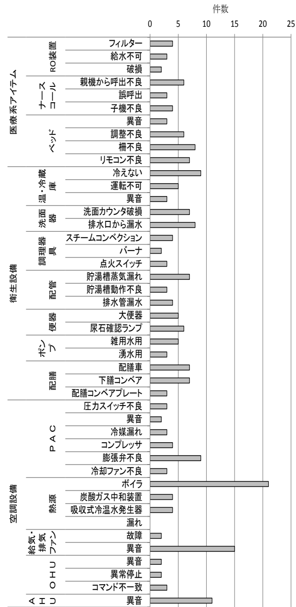
図7 修復期間の長い故障・不具合の設備区分別内訳2の件数 (修復日数8日以上、A 病院)
